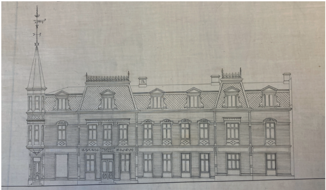
Ovan: ritning till bygglov från 1898 (Norrbottens museum R116:1-4, Kv Orren, Luleå stad. . Entréer till butiker mot Köpmangatan Nedan: ritning till fasadändring från 1905. Entréerna borttagna och istället för butiker är det lägenheter. Den rustiserade bottenvåningen är ändrad till att vara klädd i tegel. Putsornamneteringen är något förändrad (Luleå stadsarkiv, Dnr 1619).
